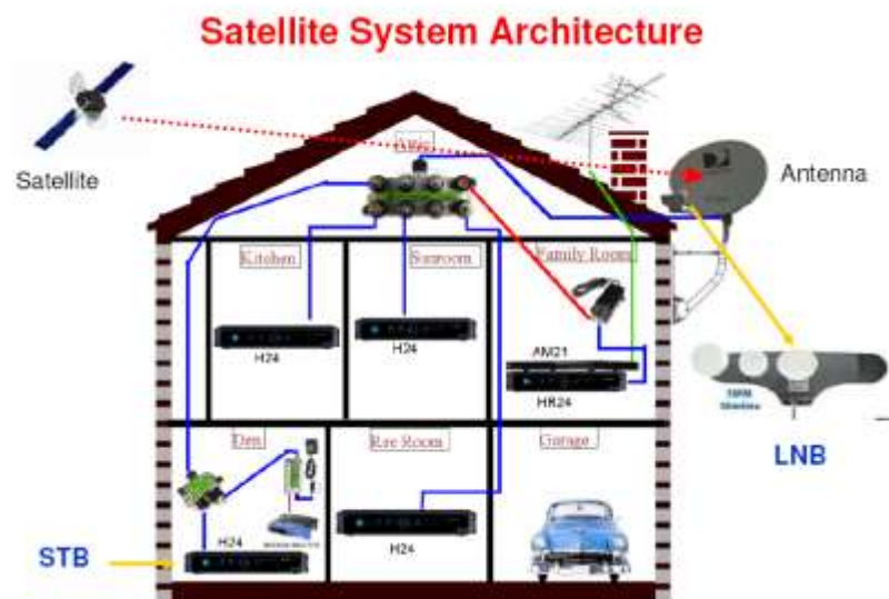
圖三、衛星電視訊號接收示意圖
